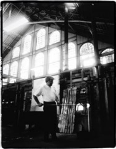
Cueille du cristal en fusion dans le four à bassin - Atelier à chaud Picking of melting crystal from the oven in the hot workshop Von der Glasschmelze, die aus dem Ofen kommt, wird ein Teil abgetrennt
